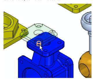
Para situar completamente la pieza, repita los pasos previos comenzando con una cara cilíndrica diferente en la tapa superior, y una cara cilíndrica correspondiente en el compartimiento de válvula. Después de situar completamente la válvula, aparecerá sombreada y no transparente.
