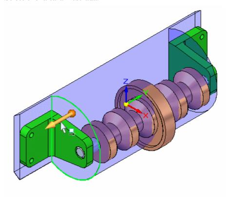
Rote la vista a la vista derecha y mueva la cara a algún lugar entre la cara del soporte y la próxima cara del eje. La colocación exacta no es importante. Como la pieza es simétrica en relación a la base, las Reglas activas controlan el comportamiento de manera que la cara opuesta también se sitúe correctamente.
