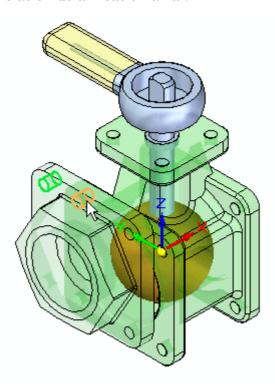
Para la última relación necesaria para completar la colocación de la pieza, seleccione la cara cilíndrica mostrada.
