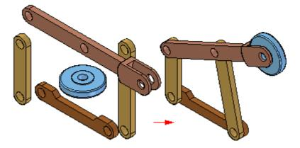
Primero, arrastre y suelte el grupo de piezas en el conjunto. Después haga clic en el comando Ensamblar y aplique relaciones entre una pieza y las otras piezas. Para colocar una pieza diferente, pulse el botón derecho del ratón.
