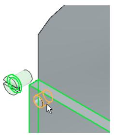
El tornillo queda colocado y totalmente posicionado, con la rotación bloqueada. Haga clic en la herramienta Seleccionar para salir. Cierre el documento de conjunto sin guardarlo.
