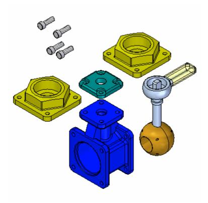
Pulse el botón derecho para liberar la última pieza seleccionada. Seleccione la tapa superior. Acerque la cara superior del compartimiento de válvula. Usando FlashFit, haga coincidir la cara inferior de la tapa superior con la cara superior del compartimiento de válvula, como se muestra.
