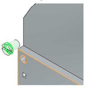
Para la relación de alineación axial, seleccione la cara cilíndrica mostrada.
