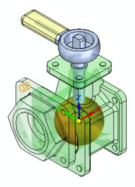
Para la cara de destino, seleccione la cara cilíndrica mostrada. Se aplica la relación de alineación axial.
