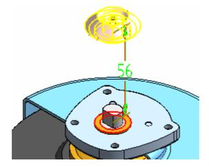
Cuando sitúa una pieza usando una relación de coincidencia con desplazamiento flotante (el valor del desplazamiento lo controla otra relación), se crea una cota dirigida, la que no se puede editar para reposicionar la pieza. Se admiten cotas de valor cero y negativo.
