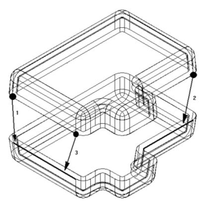
• Punto a Plano En el siguiente ejemplo, el pasador inferior derecho se ha colocado hasta una profundidad que apenas toca la superficie de un plano de referencia.
