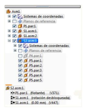
En el entorno Conjunto, PathFinder está dividido en dos paneles. El panel superior muestra los componentes del conjunto activo en una estructura de árbol de carpetas. Entre los componentes listados pueden incluirse: piezas, subconjuntos, planos de referencia de conjunto y bocetos de conjunto.
