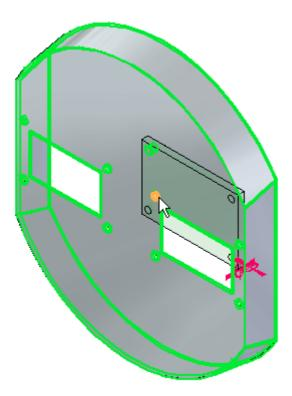
Pulse el botón derecho o Aceptar para aceptar. Se aplica la relación de alineación axial y la pieza queda totalmente situada.
