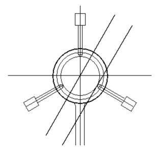
• Cono a cono: En el ejemplo siguiente, el cono en la pieza de sujeción está conectado al cono en el agujero avellanado en la placa. Cuando se agrega una relación de conexión entre dos caras cónicas, el punto significativo que representa la intersección teórica de los conos individuales está conectado.
