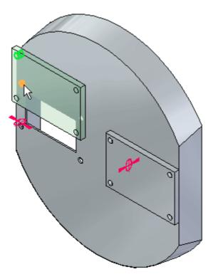
Se aplica la relación de alineación axial y la pieza queda totalmente situada.
