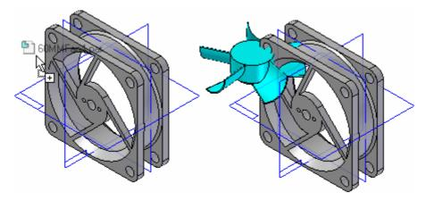
Si no fija la opción No crear una ventana nueva al poner pieza, la pieza se coloca en el conjunto de tal manera que los planos de referencia base del documento de pieza (A) coinciden con los planos de referencia base del conjunto (B).
