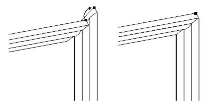
• Punto a línea: En el ejemplo siguiente, se ha aplicado una relación de coincidencia entre las caras de las dos piezas. Debido a que los lados de cada pieza son desmoldeados, no hay caras de pieza que pueda usar para aplicar una
