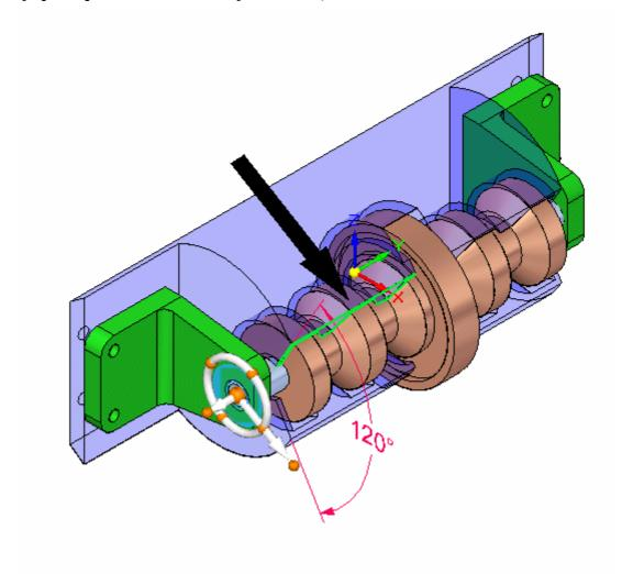
Seleccione el toroide del controlador de volante como se muestra y gírelo con el ratón. Observe que cambia el ángulo del corte en la pieza de plástico.
