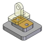
Cuando es posible FlashFit mueve la primera pieza seleccionada al aplicar la relación, y la segunda pieza permanece fija. Si la primera pieza seleccionada está completamente restringida, se mueve la segunda pieza.
