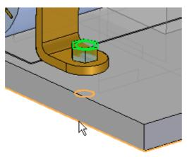
► Haga clic en la herramienta Seleccionar para salir del comando Poner pieza. Seleccione *10mm\_nut.par* en PathFinder de Conjunto, y en el plano inferior, haga clic en la relación de alineación axial.
