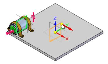
Coloque el archivo 10mm\_nut.par. Establezca la relación de coincidencia con el plano inferior de la placa.
