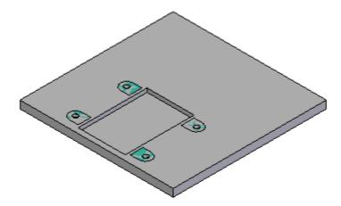
Haga clic en el comando Redondear. Seleccione los bordes superiores del vaciado e introduzca un radio de 2,5 mm. Vea la muestra y termine el redondeo.
