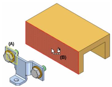
Después de seleccionar la cara de destino para la primera relación, se recoloca el conjunto de piezas, y se resalta la cara en la pieza de colocación para la segunda relación de posicionamiento (A). Puede seleccionar la cara de destino en el conjunto para satisfacer la segunda relación (B).
