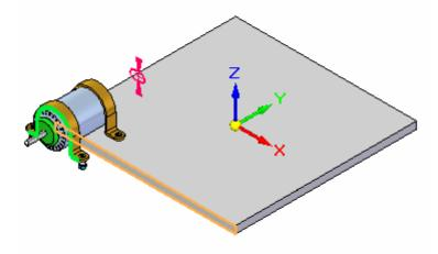
Ahora se va a establecer la relación de coincidencia entre el plano de referencia del motor y el plano de referencia de la placa. Haga clic en el plano de referencia mostrado.
