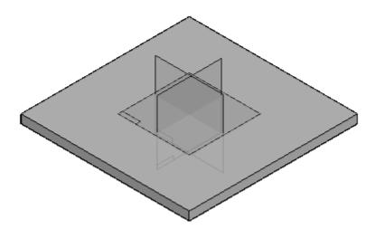
El plano derecho (y-z) de la pieza *base\_plate.par* se utilizará para situar el motor en la pieza. Se pueden desactivar los planos de referencia del conjunto.
