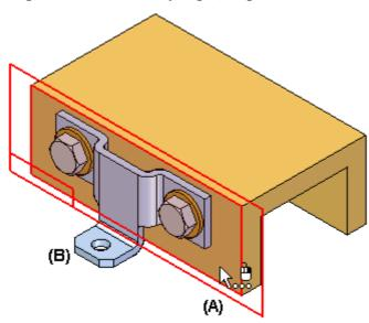
Después de la colocación, las piezas se comportan exactamente como cualquier pieza del conjunto. El propio documento de la biblioteca de subsistemas no se coloca en el conjunto. Se utiliza como un contenedor que define los componentes del sistema.
