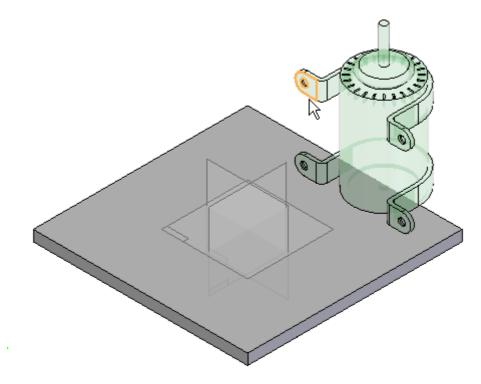
Seleccione la relación Alineación plana, y alinee la cara delantera del soporte del motor en *motor.par* con la cara vertical de *base\_plate.par*. Establezca el desplazamiento fijo en 15 mm.
