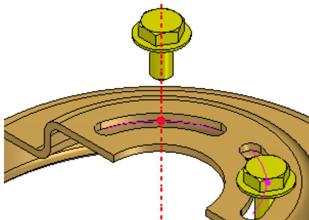
Un eje inferido, perpendicular al plano de referencia del boceto que contiene el punto, define el eje para la relación de alineación axial. El arco y el punto se han dibujado de tal forma que, si el tamaño de la ranura cambia, ambos se actualizarán oportunamente.
