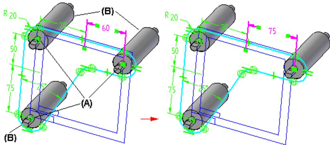
Cuando una ventana de boceto está activa, puede utilizar la Herramienta de selección y las opciones de la barra de comandos Colocar componente 3D para especificar si el boceto controla la posición del componente 3D o si el componente 3D controla la posición del boceto. En el ejemplo anterior, se había establecido la opción Boceto directriz para los rodillos con la intención de especificar que el boceto controlaba la posición de los componentes 3D.
