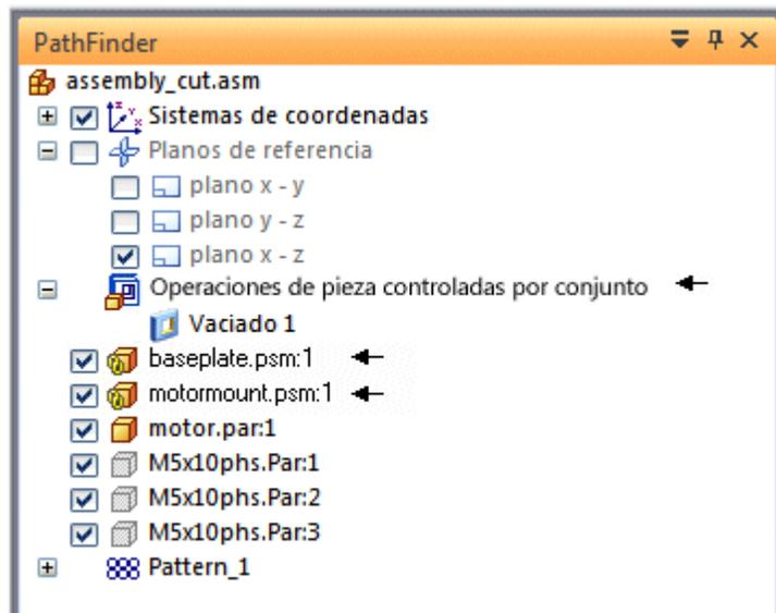
*baseplate.psm* y *motormount.psm* se muestran ahora como vinculados asociativamente al boceto de conjunto. Los archivos *baseplate.psm* y *motormount.psm* son modificados por los vaciados. Puede investigar esto guardando y cerrando este archivo. Después abra *baseplate.psm* o *motormount.psm* para verificar la modificación.
