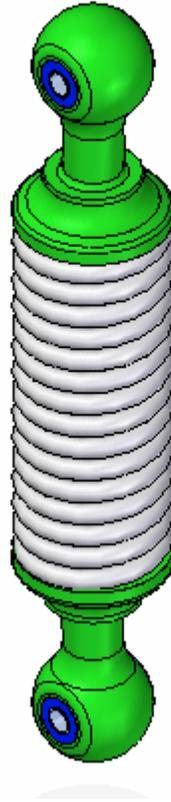
*shock\_top.asm* aún se puede mover a lo largo del eje de los cilindros. Moverá esta pieza y el resorte ajustará su tamaño en base a la posición de este subconjunto.
