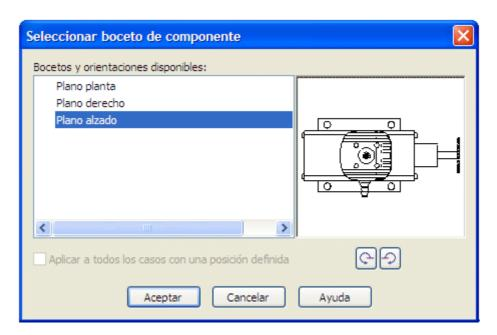
Observe los avisos. En el teclado, pulse A para rotar el motor a la posición indicada. Haga clic a la izquierda del boceto y coloque el componente aproximadamente donde se muestra.
