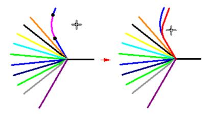
Puede girar el segmento haciendo clic y arrastrando el segmento (A) para que se ajuste en la vista de dibujo (B).
