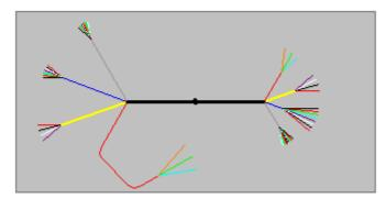
Puede usar el Comando Insertar plegado para crear un plegado en la geometría desarrollada de manera que entre en la vista de dibujo de la tabla de clavos. Puede definir el radio y el ángulo de barrido para el plegado. Solid Edge inserta el plegado basado en esta información, y mantiene la longitud total del ramal.
