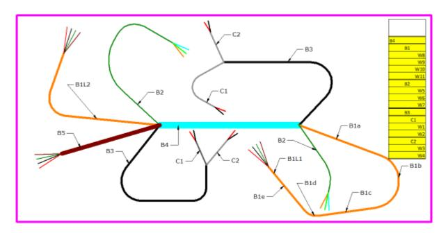
La geometría desarrollada se coloca en una escala1:1 y puede editar la geometría para que se ajuste correctamente en la placa. Después que la geometría desarrollada se coloca correctamente, puede imprimir la vista de la tabla de clavos.
