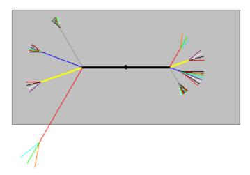
Atributos, como la longitud, el color y el grosor de línea, corresponden a la información almacenada para el diseño del cableado.
