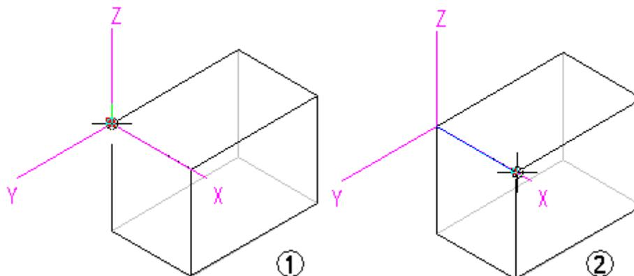
Dans les environnements Pièce, Tôlerie et Assemblage, la commande Mesurer angle permet de mesurer les angles. Vous pouvez effectuer une mesure entre deux faces ou trois points quelconques.
