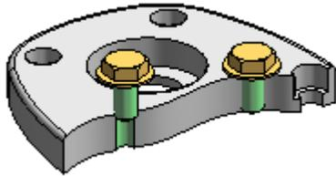
La vérification d'interférences peut signaler ou ignorer l'interférence entre les filetages et les taraudages de pièces raccordées. Par exemple, l'interférence créée par l'utilisation d'une vis autotaraudeuse dans un perçage sans taraudage est généralement ignorée. Par contre, l'interférence créée par une vis qui est plus longue que la profondeur de taraudage doit être signalée.
