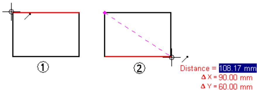
Lorsque vous cliquez sur le point-clé, il s'ajoute à la série des points de mesure. Vous pouvez ensuite sélectionner un autre point pour afficher la nouvelle distance linéaire et deltas (3) ou cliquer ce point pour afficher la distance entre les deux derniers points et la distance cumulée totale séparant l'origine du dernier point (4). Cliquez sur le bouton droit de la souris pour réinitialiser la commande.
