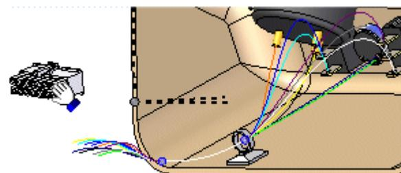
Dopo aver spostato il componente nella nuova posizione, si verifica l'aggiornamento automatico del collegamento ai conduttori.
